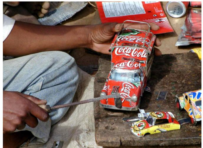
Die Modelle sind aus vielen Einzelteilen wie z.B. Dach Kotflügel, Türen zusammengesetzt. Für jede Art, in jeder Größe, fertigt sich der Produzent bei der ersten Musterproduktion ein Set mit Schablonen. Diese Schablonen werden dann, als persönliches „Betriebsgeheimnis“ gehütet, zum Anreißen und Ausschneiden bei der späteren Serienfertigung genutzt. Die Arbeitsschritte Säubern, Schneiden und Anreißen erledigen oft die Frauen oder Jugendlichen der Familien.
